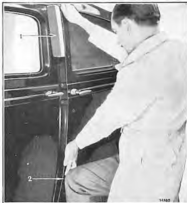
FIG. 10—Straightening a Sprung Door
